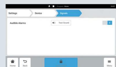
**Um den akustischen Alarm zu testen, tippen Sie auf die Schaltfläche Test Ton-Taste**
