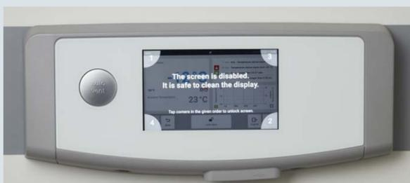
**Touchscreens können durch Sperren des Bildschirms gereinigt werden: Tippen Sie auf Menü > Bildschirm reinigen – der Touchscreen ist nun gesperrt und bereit für die Reinigung**
